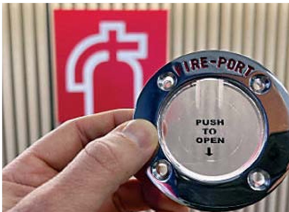
Kuvassa paloportti, jonka voi asentaa moottoritilan seinämään sisämoottoriveneissä. Sitä kautta sammuttaminen on turvallisempaa ilman luukkujen avaamista.
